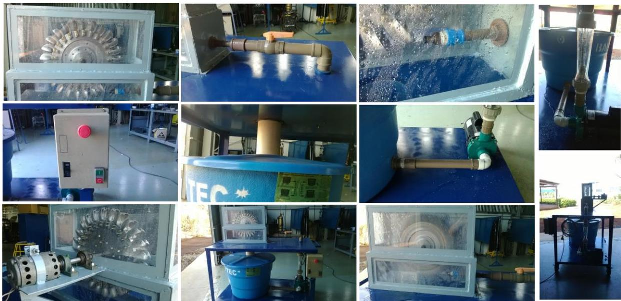
Figura 11 - Partes constituintes e bancada didática com turbina Pelton montada.
