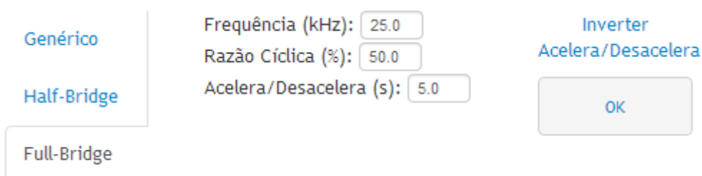
Figura 8 – Modo de geração de pulsos “Full-Bridge”.
