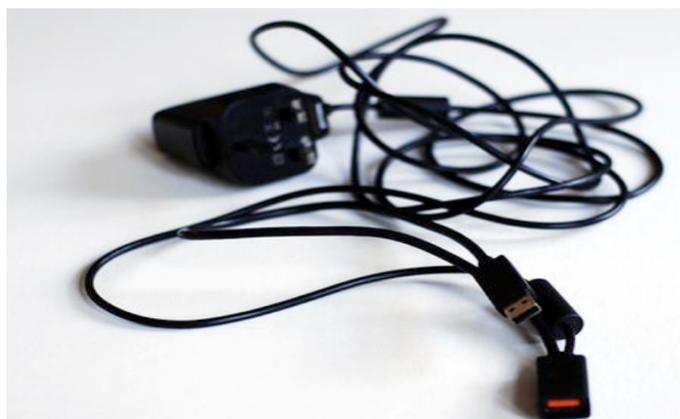
Figura 7 – Adaptador USB para o conector proprietário do Kinect (MELGAR, 2012).
