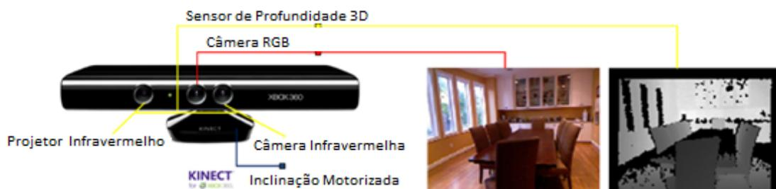
Figura 2 – Hardware do Kinect Sensor e duas imagens capturadas pela câmera RGB (imagem da esquerda) e pela câmera de profundidade (imagem da direita). Fonte: Adaptado de Han (2013).
