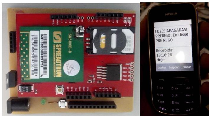
Figura 9 – Kit WEB/GPRS e uma das interfaces com usuário.
