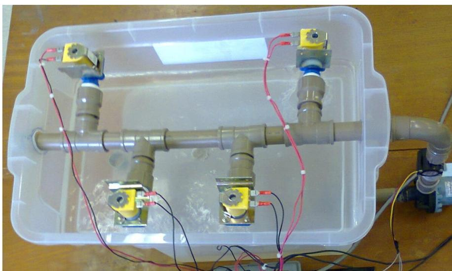
**Figura 4** - Vista superior do protótipo do sistema inteligente de controle de inclinação de balsas.
