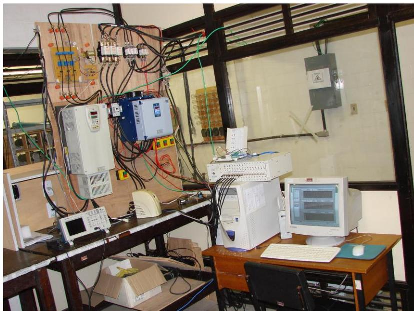
Figura 2 – Sistema de acionamento e monitoração da bancada.
