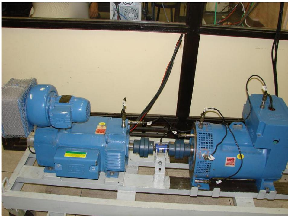
Figura 3 – Motor de corrente contínua (esquerda) e gerador síncrono trifásico (direita).
