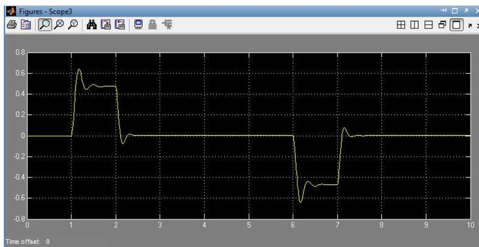
Figura 8: Resposta do sistema com o controlador Fuzzy
