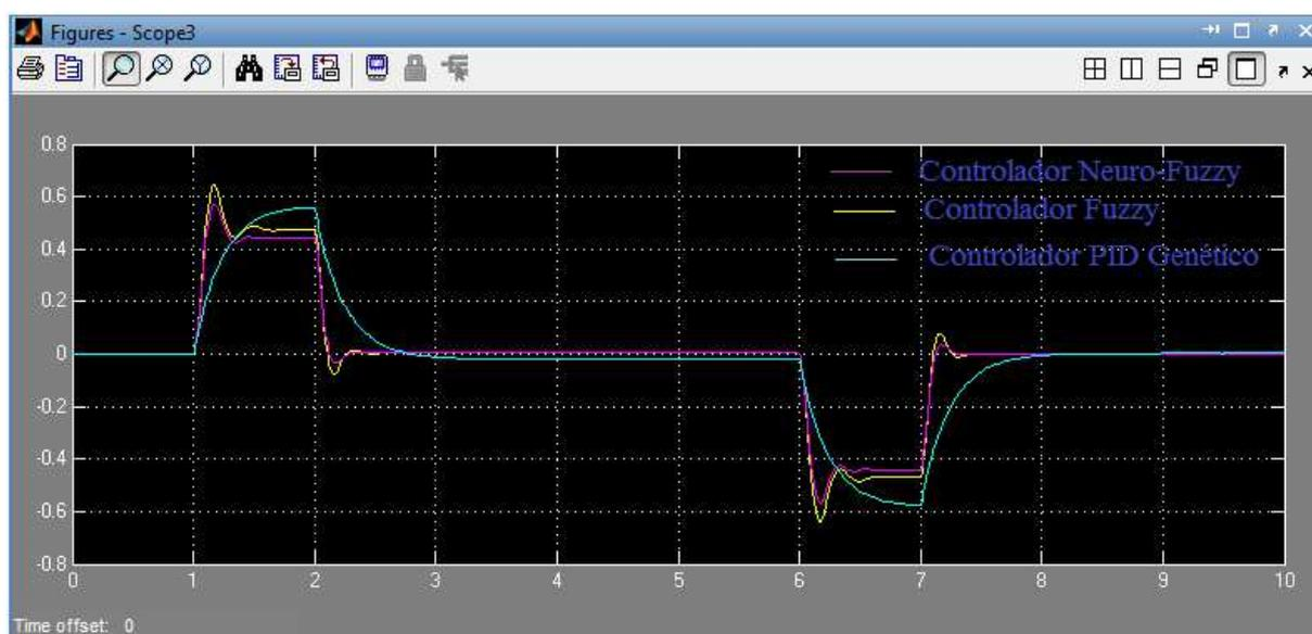
Figura 11: Resposta do sistema com todos os controladores propostos.
