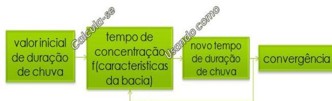
Figura 4 - Esquema para calcular a duração da chuva de projeto
