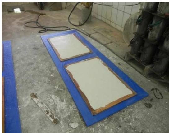
Figura 3 – Corpos-de-prova moldado com pasta de gesso e adição de 1,00% de mucilagem em pó.
