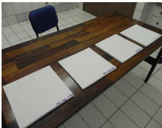
Figura 1 - Corpos de prova para ensaio de absorção em sala climatizada.
