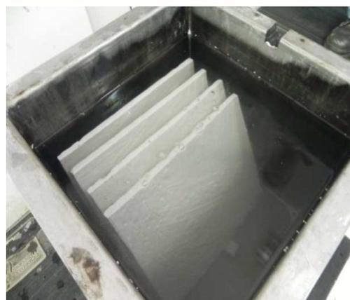
Figura 2 - Corpos de prova após imersão em recipiente com água.
