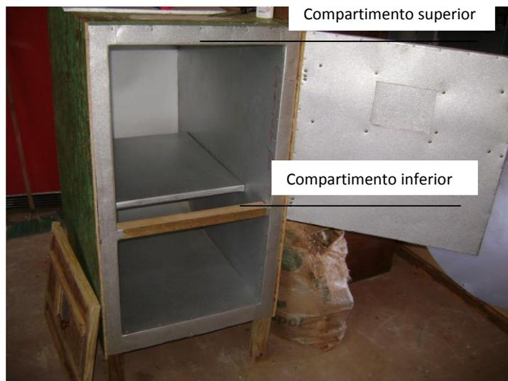
**Figura 2 – Divisão interna do desidratador revestido com chapa galvanizada:**
