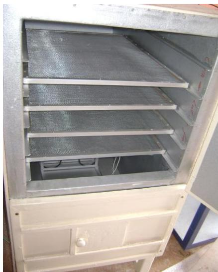
**Figura 3 - Fixação das cantoneiras para assegurar as bandejas dentro do desidratador.**
