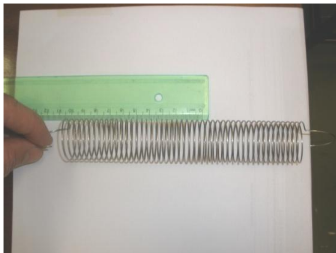
Figura 3 - Foto da medida da elongação da mola vista de cima.
