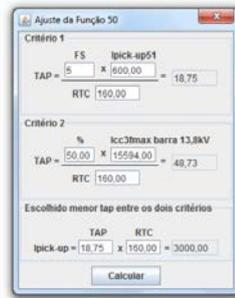
Figura 5: Configuração do ajuste da função 50
