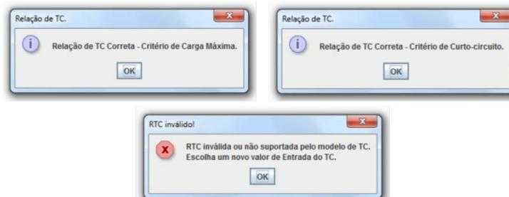
Figura 3: Verificação do dimensionamento do TC
