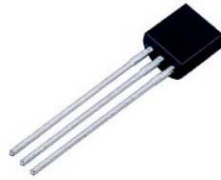
Figura 2 – Sensor de Temperatura LM35 (ADISSI, 2009)
