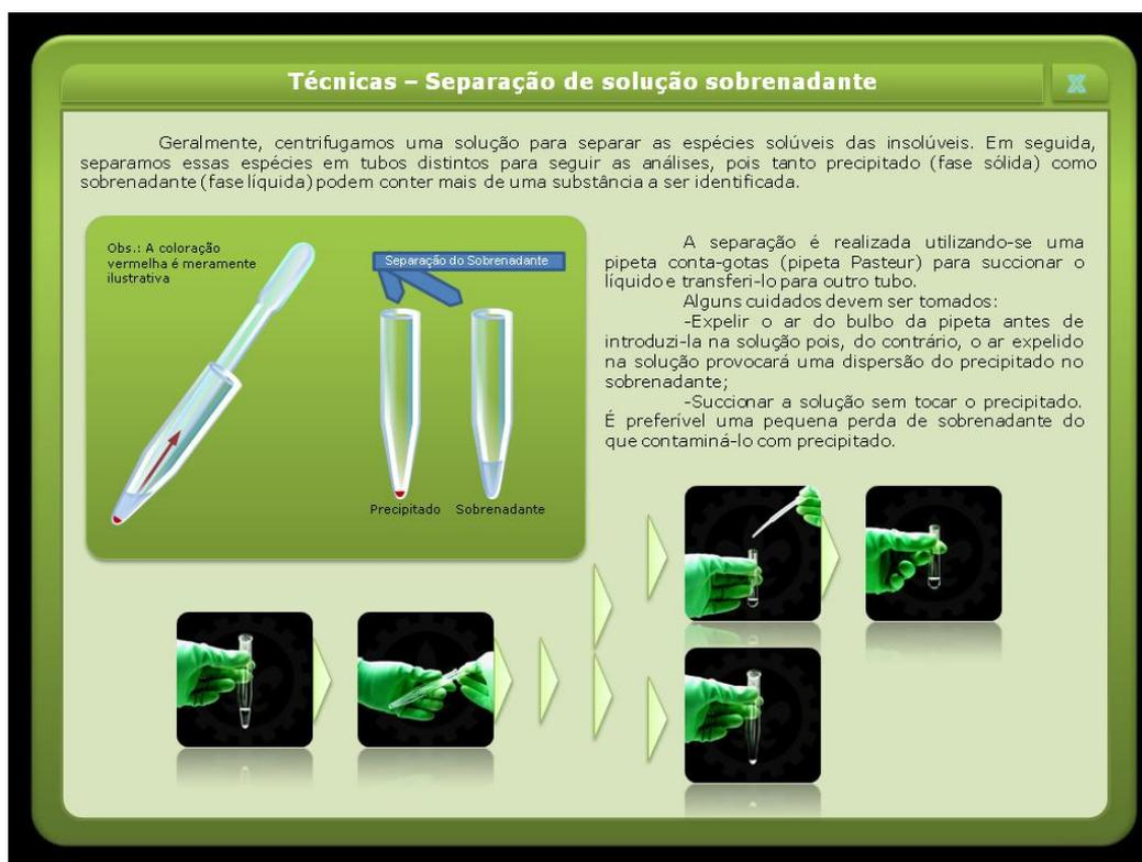
Figura 3 - Layout secundário ilustrando uma técnica necessária para realizar o experimento.
