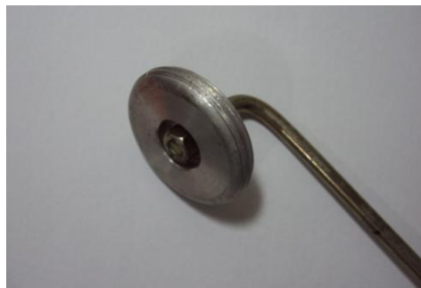
Figura 7 – Laminador manual utilizado no processo de preparo das mantas.
