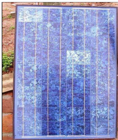
Figura 3 - Painel solar de silício policristalino instalado no Colégio Politécnico.
