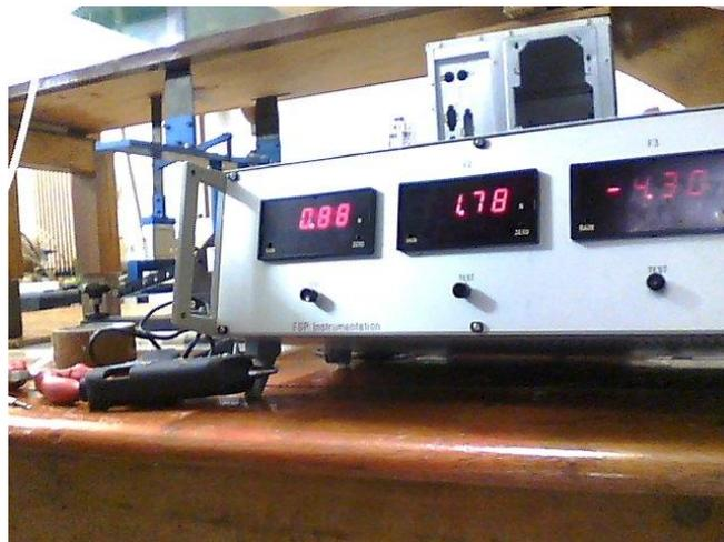
Figura 6: Equipamento que mostra as forças atuantes nos dinamômetros da balança aerodinâmica.
