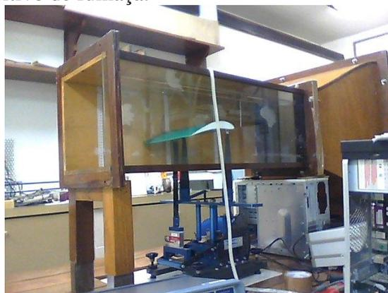
Figura 2 - Um Perfil posicionado dentro de um túnel de vento.
