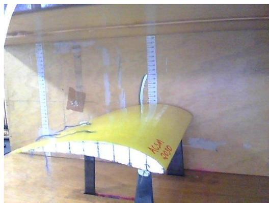
Figura 5: Asa pronta para ensaio no túnel de vento.
