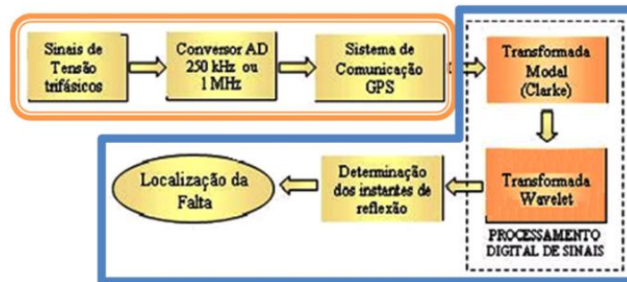
Figura 2 – Diagrama de blocos do localizador
