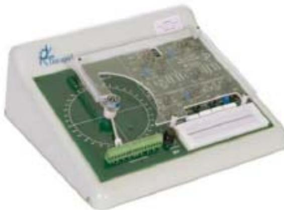
Figura 1- Kit servomecanismo Datapool.
