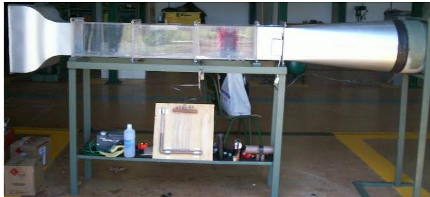
Figura 9 – Túnel de vento construído.
