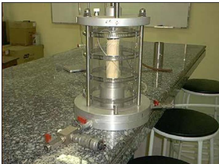
Fig. 1: Célula contendo o corpo de prova do ensaio de compressão triaxial.
