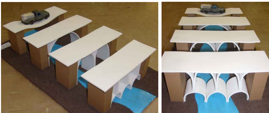
Figura 2 – Soluções em arco para a sustentação do tabuleiro.
