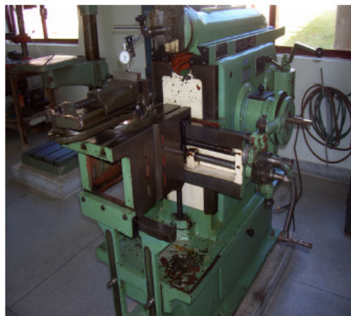
Fig. 3. Montagem para avaliar a superfície do aplainamento.
