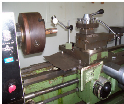
Fig. 1. Montagem para avaliar a superfície do torneamento.
