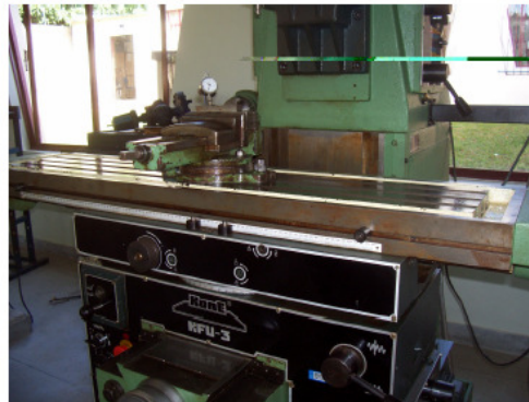
Fig. 2. Montagem para avaliar a superfície do fresamento.
