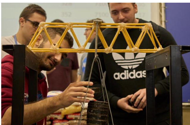
Figura 2a – Ponte de espaguete sendo testada
