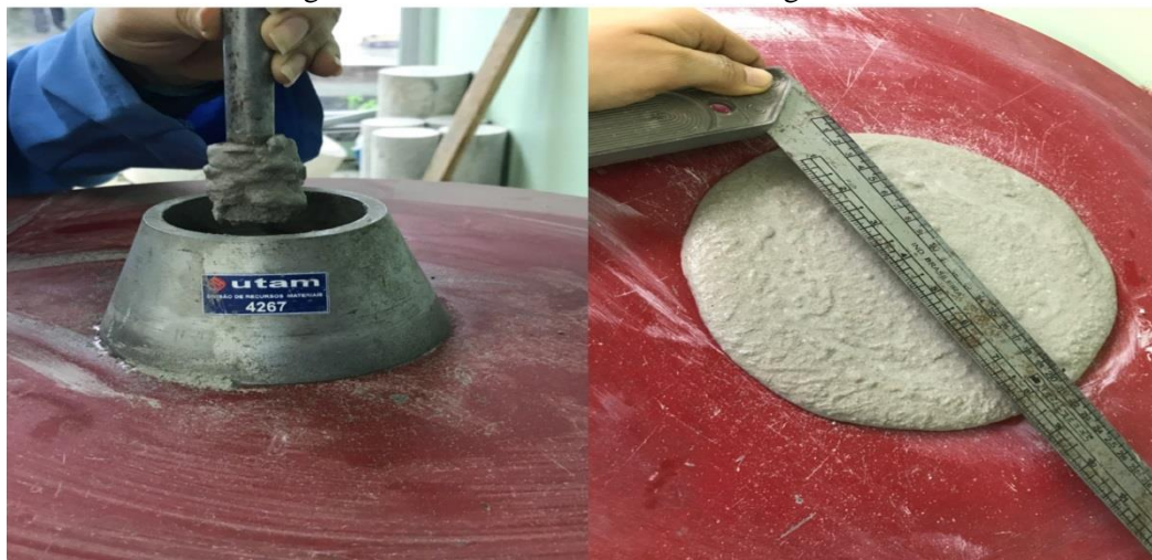
Figura 4 – Ensaio de consistência da argamassa
