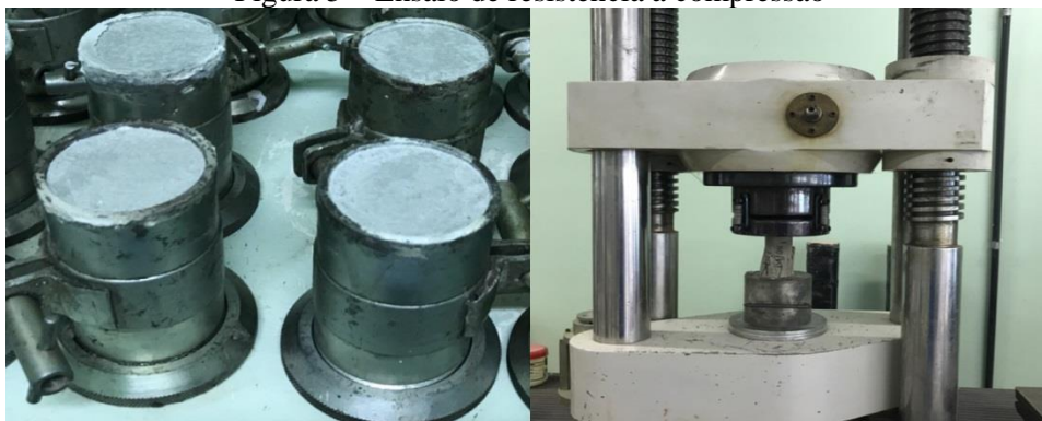
Figura 5 – Ensaio de resistência a compressão
