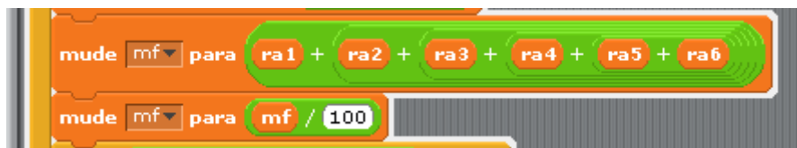
Figura 8: cálculo do módulo de finura da areia
