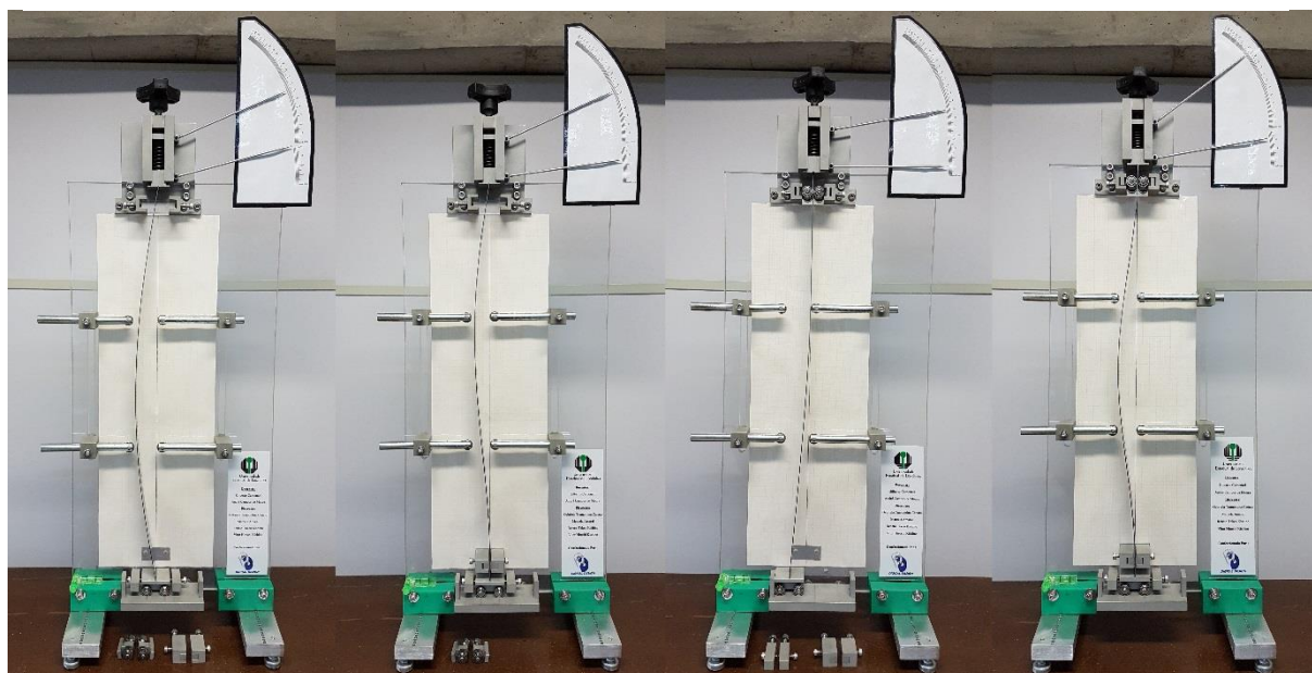
Figura 6 – Modelo pós-flambagem nas configurações: (a) birrotulada; (b) engastada-rotulada; (c) engastada-livre; (d) bi-engastada
