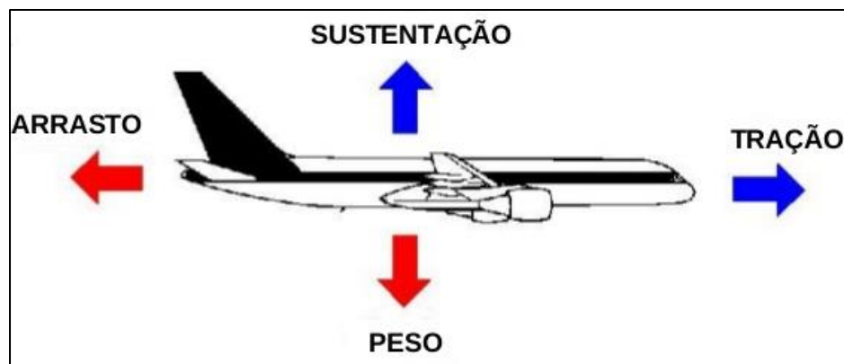
Figura 1. Forças atuantes numa aeronave em voo reto horizontal (RODRIGUES, L. E. M. J, 2013).
