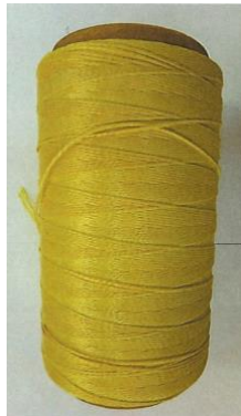
Figura 3 – Rolo de Kevlar® DuPont 29 Twisted Cord utilizado.
