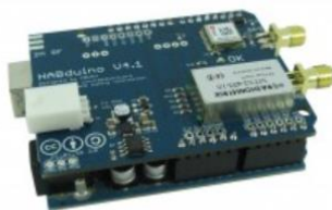
Figura 6 – Placa de HABduino utilizada para rastreamento.
