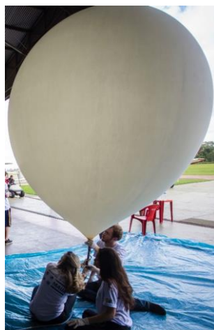
Figura 2 – Balão de látex de 2000 g utilizado.
