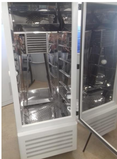
Figura 7 - Montagem da incubadora.
