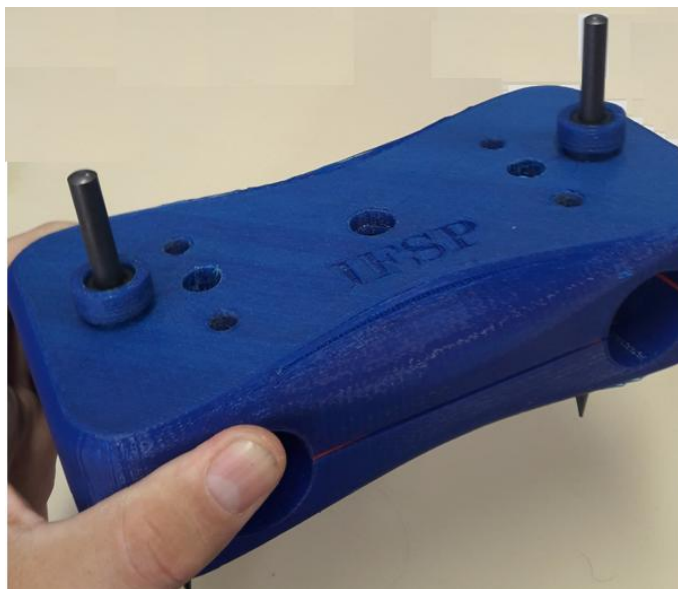
Figura 7 – Protótipo com os eletrodos de grafite instalados.
