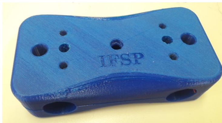
Figura 6 – Protótipo manufaturado em PLA.
