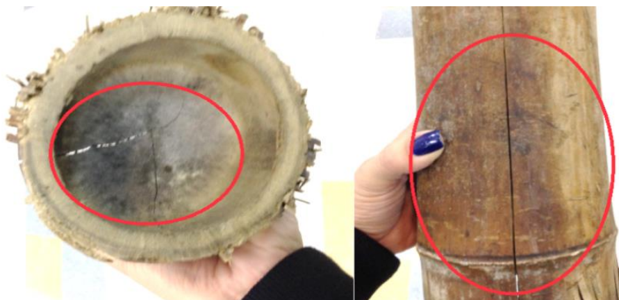
Figura 8 - Rompimento do CP de 20cm de comprimento
