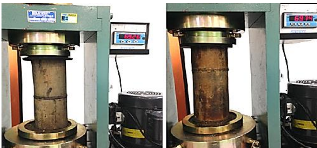
Figura 6 - Primeiro e segundo teste de compressão axial.
