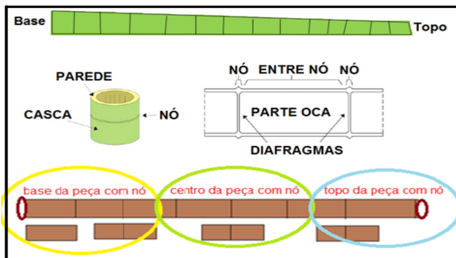
Figura 4 – Formato cônico da vara de Bambu
