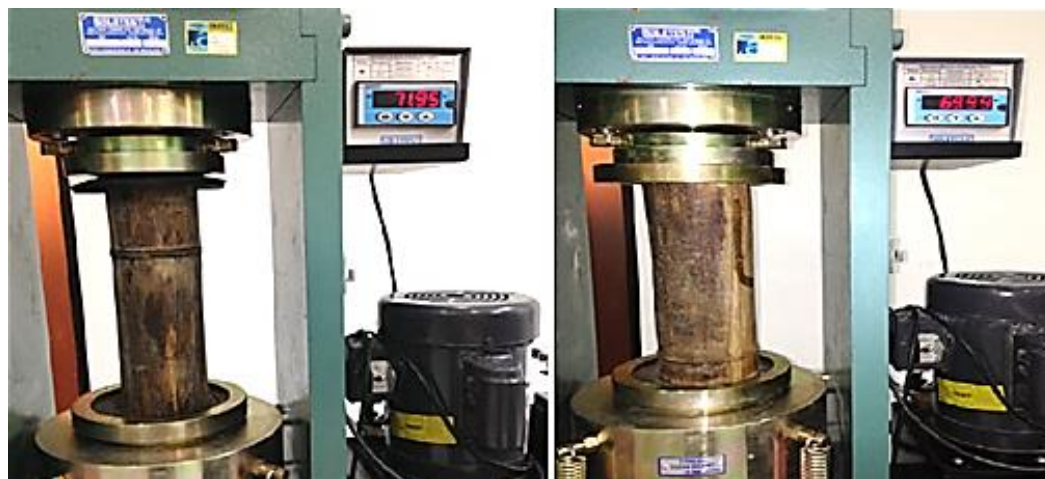
Figura 7 - Terceiro e quarto teste de compressão axial
