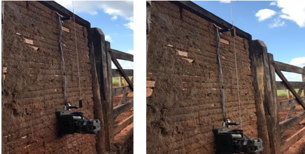
Figura 5– Motor responsável pela abertura e fechamento da zona 1.
