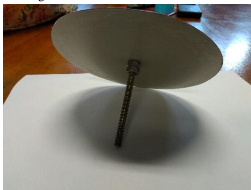
Figura 2- ferramenta de corte montada.
