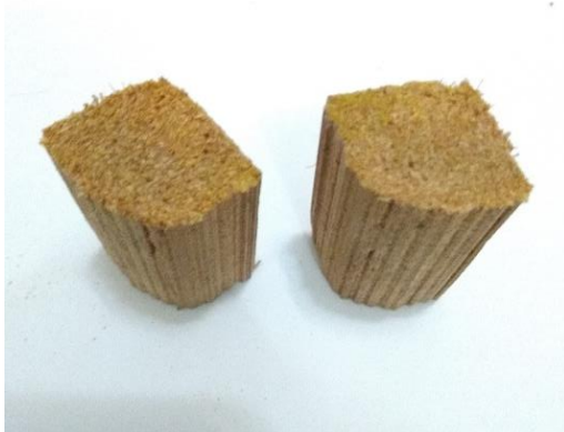
Figura 4: Corte em uma amostra de miriti utilizando o dispositivo montado.
