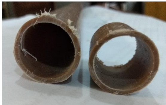
Figura 6- Corte em um tubo de pvc com o dispositivo montado.
