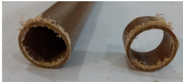
Figura 5- Corte em um tubo de pvc com a serra simples.
