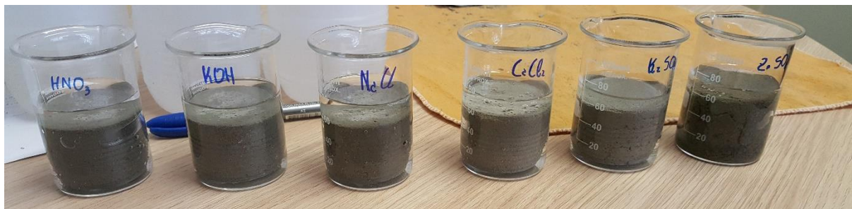
Figura 5 – Método de cura por imersão por 28 dias.
