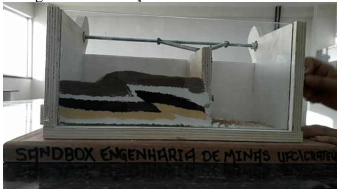
Figura 14 - Formação de zona de cisalhamento
