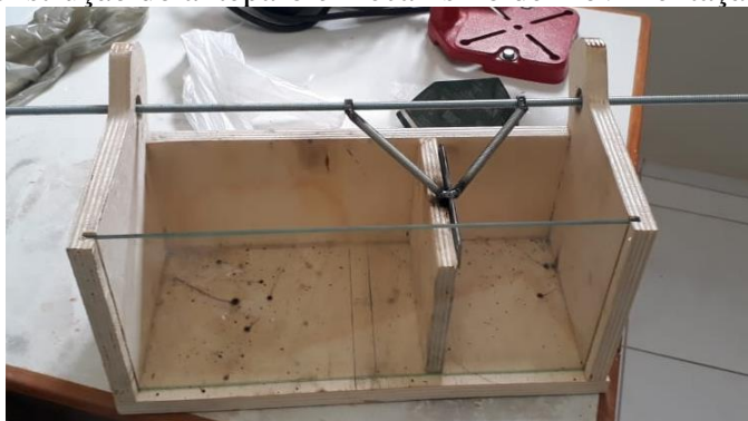
Figura 7 - Construção do anteparo e mecanismo de movimentação dos estratos
