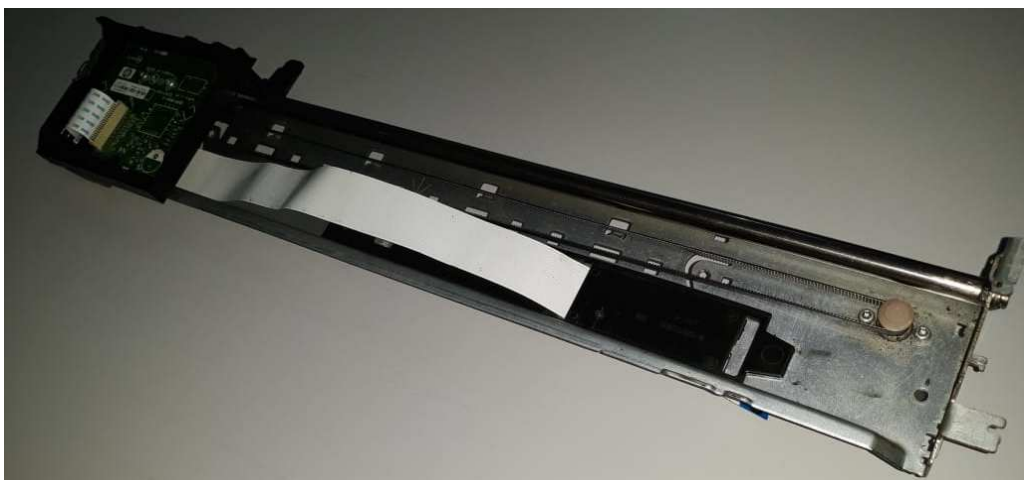
Figura 2 – Carro de impressão retirado de uma impressora a jato de tinta.
