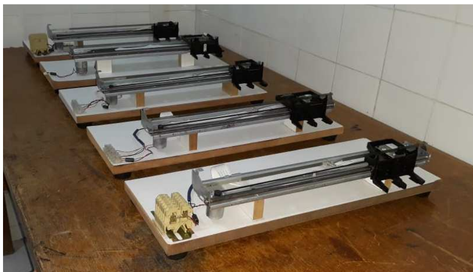
Figura 6 – Fixação dos carros nas peças de MDF.
