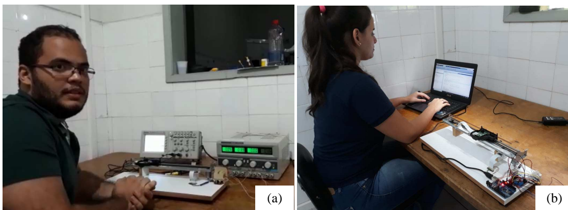
Figura 8 – (a): Processo de identificação dos sinais do encoder óptico; (b) Processo de criação do algoritmo de controle da bancada.
