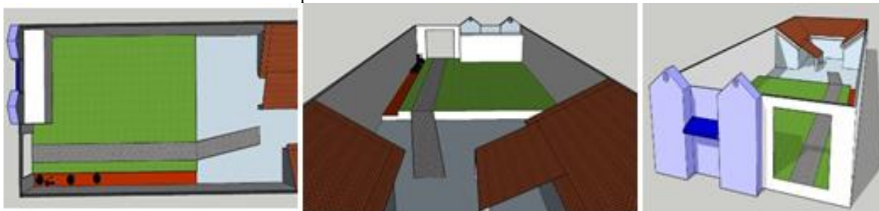
Figura 2 – Desenho do pré-projeto apresentado pelos acadêmicos mostrando de forma esquemática o local a ser aterrado e gramado com destaque para a calçada de concreto permeável a ser executada no local
