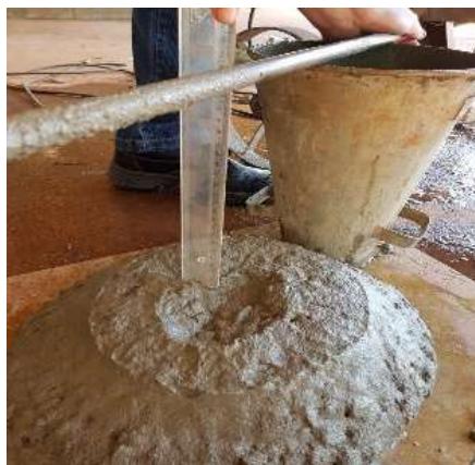
Figura 2. Ensaio de abatimento por tronco de cone.
