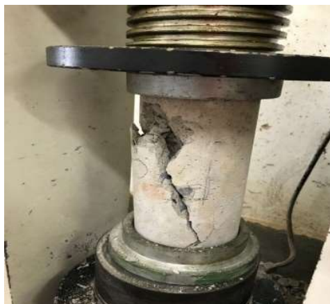
Figura 4. Ensaio de resistência a compressão.
