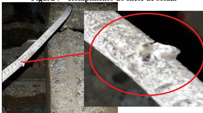
Figura 9 - Rompimento do filete de solda.
