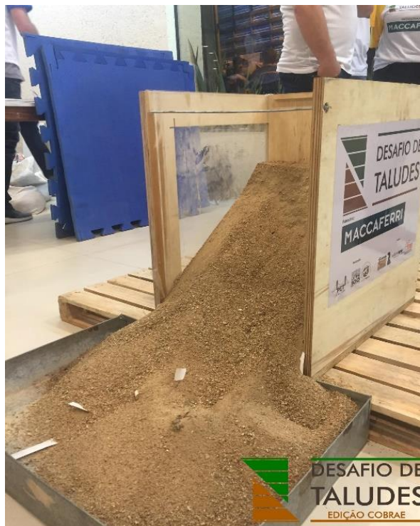
Figura 3 - Carregamento e rompimento de modelo reduzido de terra armada - Projeto Desafio de Taludes.
