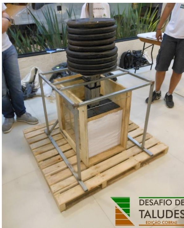
Figura 3 - Carregamento e rompimento de modelo reduzido de terra armada - Projeto Desafio de Taludes.
