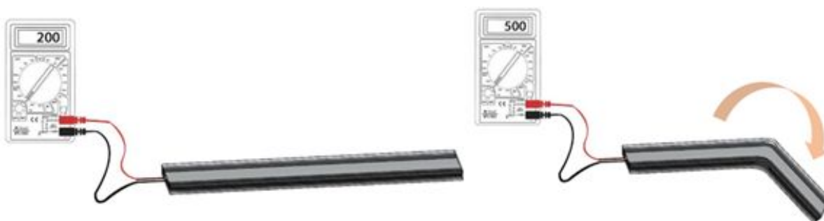
Figura 5 – Calibrar sensores individualmente seguindo os movimentos de extensão e flexão.
