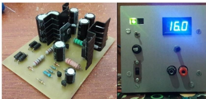
Figura 3 – Fonte Linear 16 Volts e 2 Amperes.
