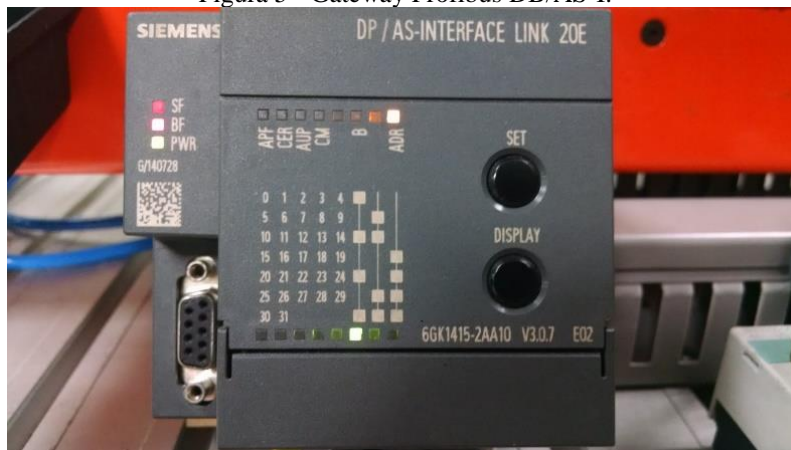
Figura 5 - Gateway Profibus DB/AS-I.
