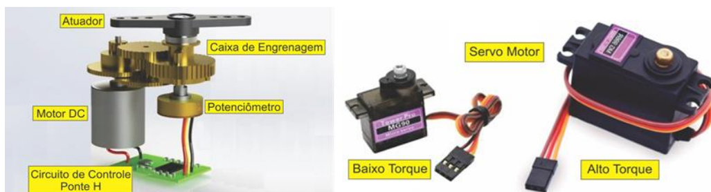
Figura 2.2 – Mecanismo do servo motor
