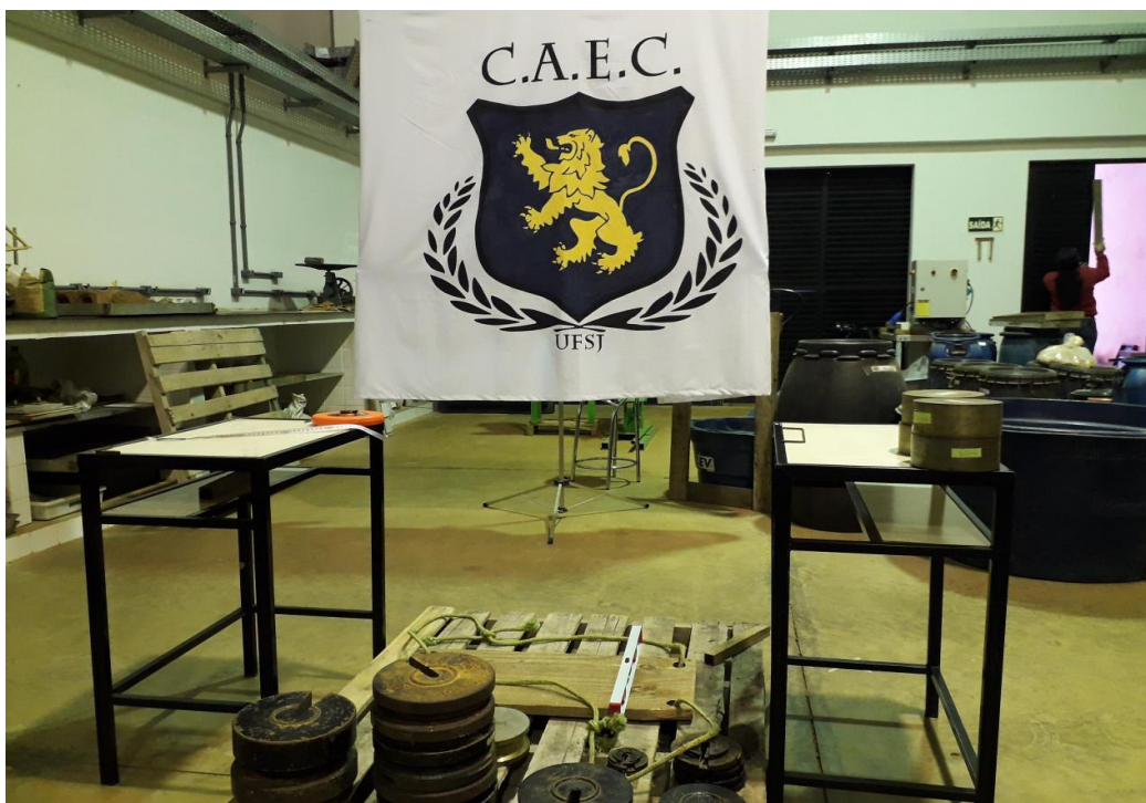
Figura 6 – Estrutura montada para a realização dos testes de carga.
