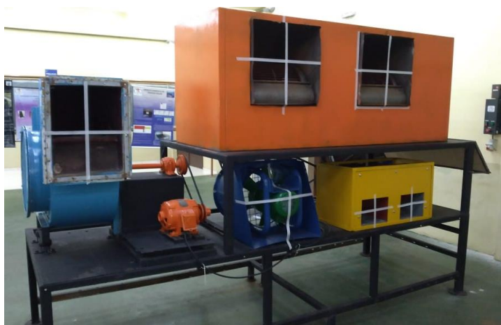
Figura 1 – Bancada de Ventilador desenvolvida.
