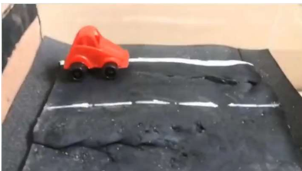
Figura 5. Fissuras e trincas ocasionadas pela execução de pavimento asfáltico sobre camada de solo saprolítico.
