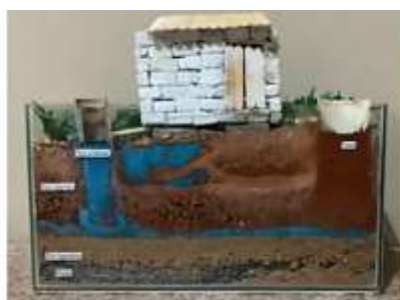
Figura 2. Modelo físico para representação do impacto de uma casa construída sobre solo laterítico após variação de umidade ocasionada por vazamento de poço de água e fossa séptica.
