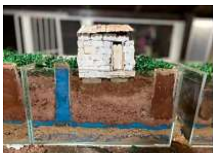
Figura 2. Modelo físico para representação do impacto de uma casa construída sobre solo laterítico após variação de umidade ocasionada por vazamento de poço de água e fossa séptica.
