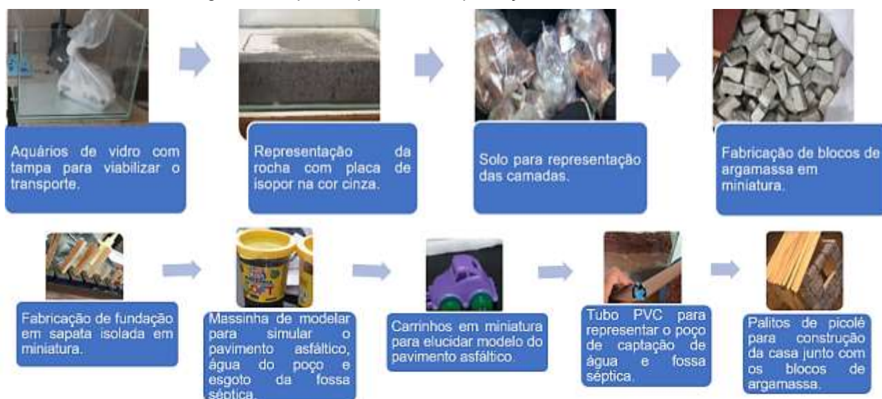
Figura 1. Etapas do processo de produção dos modelos físicos.
