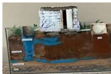
Figura 2. Modelo físico para representação do impacto de uma casa construída sobre solo laterítico após variação de umidade ocasionada por vazamento de poço de água e fossa séptica.
