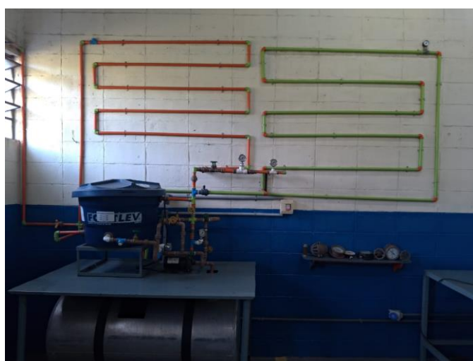
Figura 9 – Bancada para o cálculo da altura manométrica
