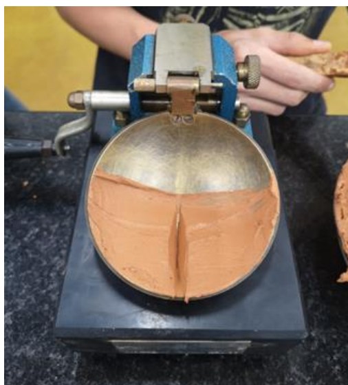
Figura 3: Amostra de solo no aparelho Casagrande
