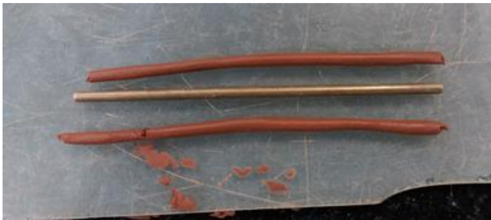
Figura 4: Solo modelado para o ensaio de limite de plasticidade
