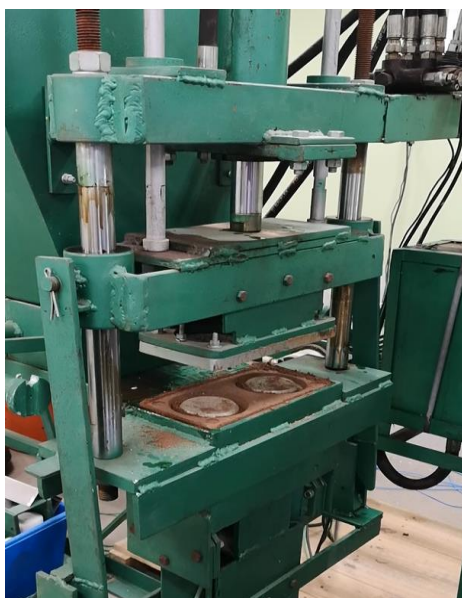
Figura 6: BSC sendo produzido na prensa hidráulica
