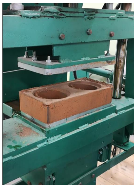
Figura 7: BSC após ser prensado na prensa hidráulica
