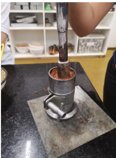
Figura 5: Corpo de prova de solo e água destilada sendo compactado
